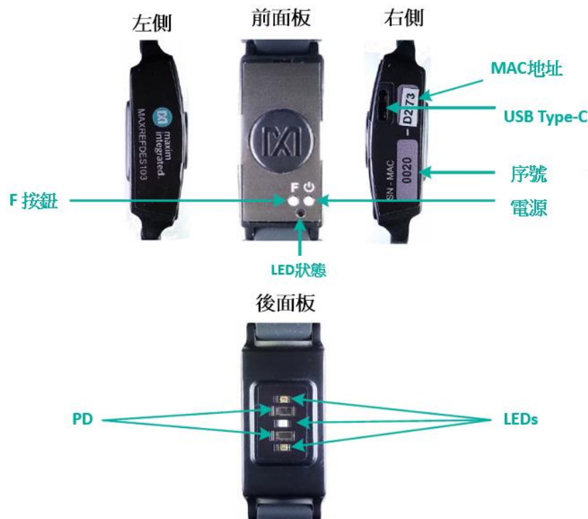
圖 1、MAXREFDES103 外觀構造說明
