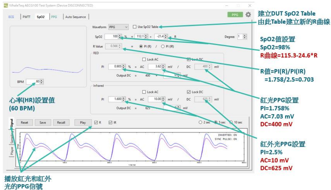
圖 6、設置 AECG 100 SpO2 AC/DC/PI/R/SpO2 參數
