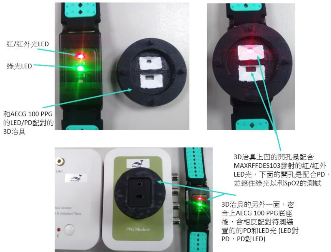
圖 2、一個配對的 3D 治具密合連接 AECG100 PPG 和 DUT，用來測試 SpO2
