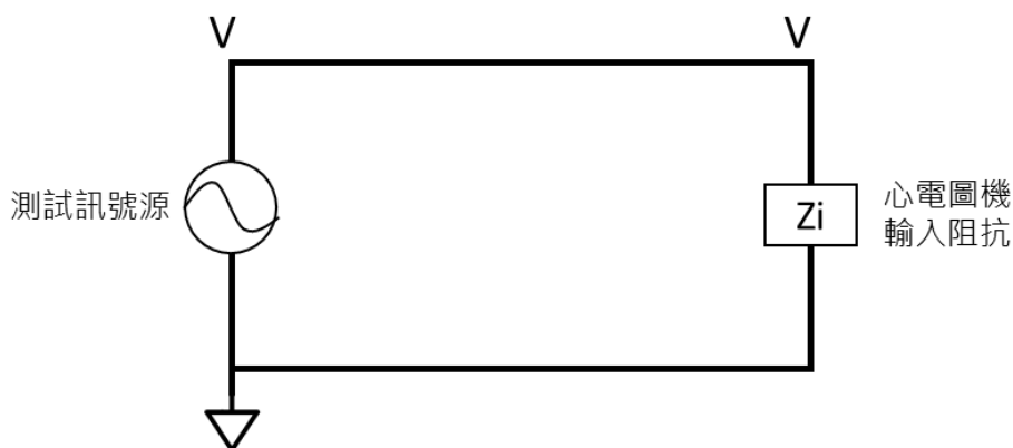
圖 1、測試線路示意圖 (未加並聯線路)， V 是心電圖機上對應導聯波形的電壓
